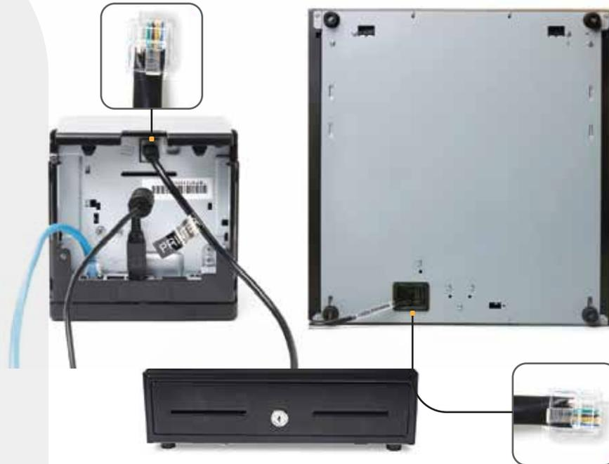
2 ثانياً : قم بتوصيل كابل التيار المتردد بمأخذ التيار الكهربائي. وتوصيل كابل الإنترنت
